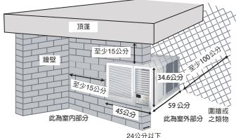
**■ 安裝時的注意事項**當安裝空調器於玻璃窗口或薄板時，垂直支持棒及側支持棒須固定於洋灰牆壁，以便空調器的重量能被洋灰牆壁支持。
